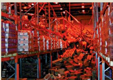
Fotografia 2. Przewrócenie się regałów wysokiego składowania
